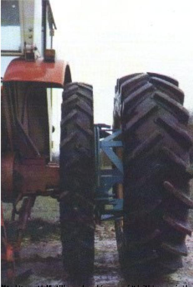
Un axe à double roue est utilisé pour les véhicules à transmission à double roue à l'arrière et à l'avant.
