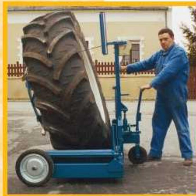
*Le treuil équipé d'une sangle permet de relever une roue adossée contre un mur et de la maintenir dans la position voulue.*
