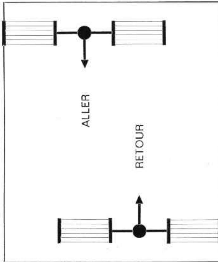
Nos ROUES-CAGES sont fabriquées en aluminium anodisé. Elles sont conçues pour permettre, au second
