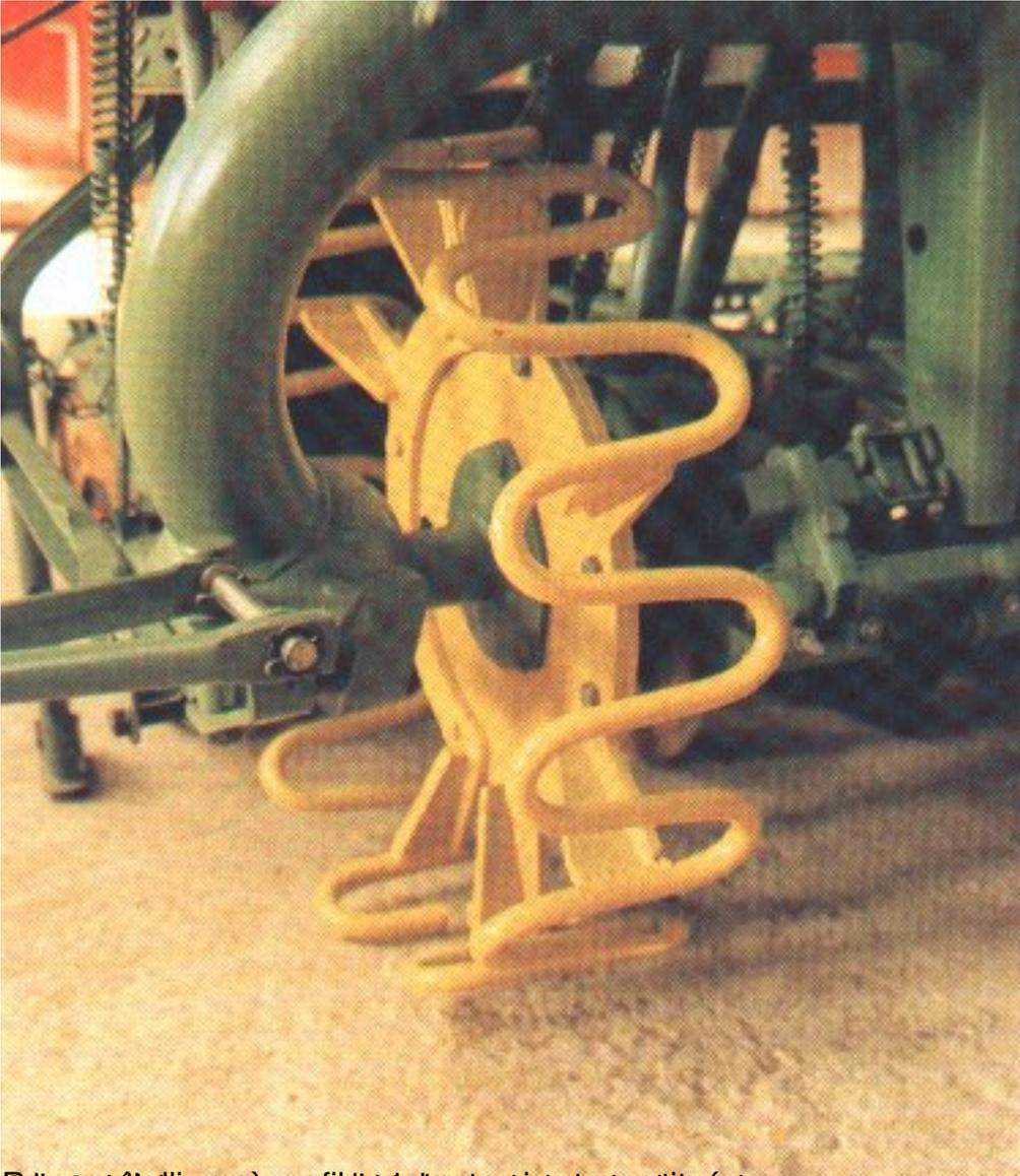
Une roue sans trace est principalement utilisée sur les semoirs et aussi les roues de
